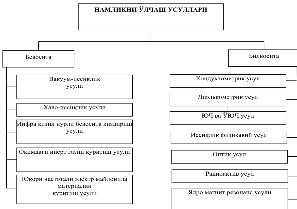
1-расм. Қаттиқ ва сочилувчан материаллар намлигини ўлчаш усуллари­нинг структура схемаси
