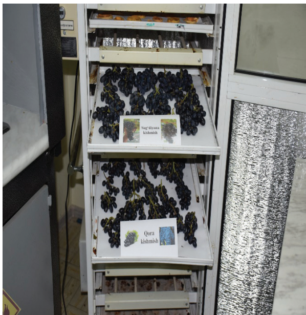
2-расм. Махсус қуритиш ускунаси “Суғдиёна” (Гигант) ва Қора кишмиш навларини қуритиш жараёни
